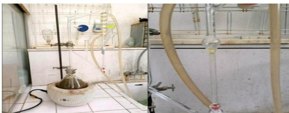
Figure 3 : Hydrodistillation de type Clevenger pour l'extraction d'huile essentielle.
